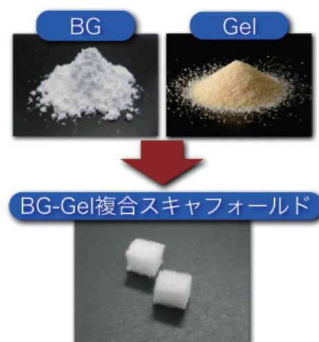
図4 Bioactive glass(BG)とゼラチンハイドロゲル(Gel)により作製されたBG-Gel複合スキャフォールド。
